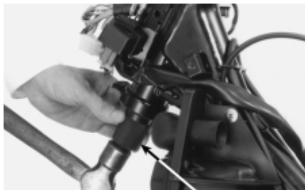
INSTALADOR DO RETENTOR DE ÓLEO
