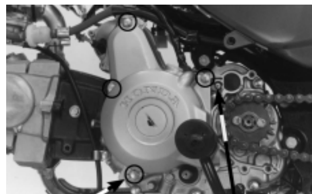
PARAFUSOS FIAÇÃO DO INTERRUPTOR DO PONTO MORTO
