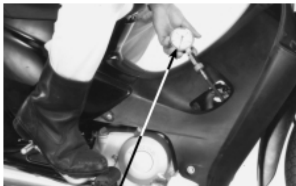
MEDIDOR DE COMPRESSÃO
